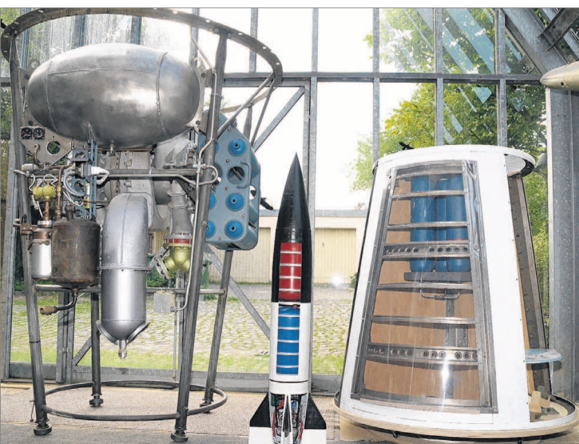
Das Modell einer A-4-Rakete, besser bekannt als Hitlers V 2, wird flankiert von zwei Originalteilen: zum einen dem Pumpenmodul (links) aus dem Heck, zum anderen dem Geräteteil mit Steuerung aus dem vorderen Teil.
